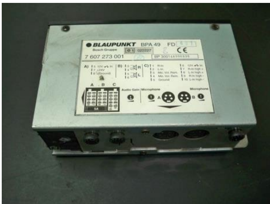
Imagen 1. Amplificador Audiobus BPA 49
